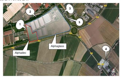
Le point 3 sera retenu comme ZER (le point 4 étant distant de plus de 200 mètres des limites de propriété). Des mesures du niveau sonore initial ont été effectuées par APAVE en mars 2018.
